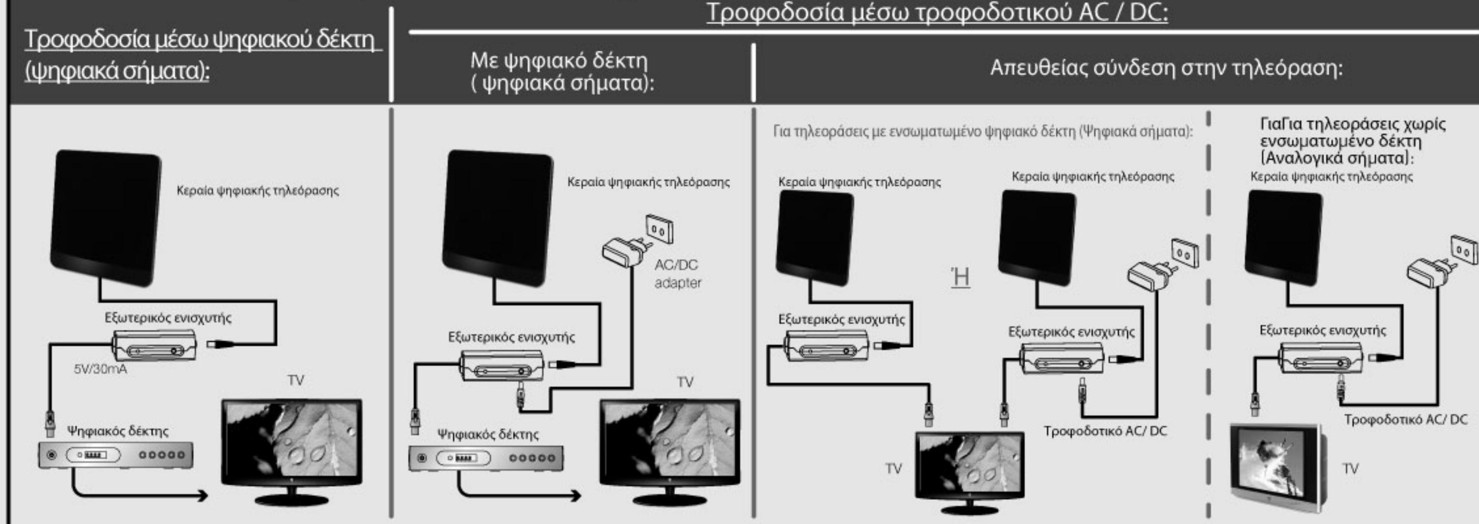
Συνδέστε το ομοαξονικό καλώδιο της κεραίας στην υποδοχή ANT του εξωτερικού ενισχυτή και συνδέστε το ομοαξονικό καλώδιο του ενισχυτή στην υποδοχή ANT του ψηφιακού δέκτη σας. Ετσι θα υπάρχει τροφοδοσία 5V / 30mA από τον ψηφιακό δέκτη.
