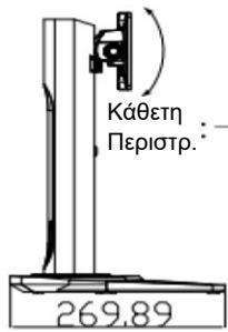
Κλίση :  $0^\circ \pm 1^\circ$   $-3^\circ -90^\circ \pm 3^\circ -1^\circ$
