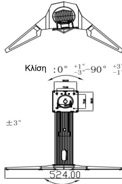
Οριζόντια Περιστροφή :  $-45^\circ \pm 5^\circ -45^\circ \pm 5^\circ$
