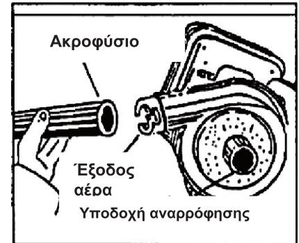
Για αναρρόφηση, τοποθετήστε το ακροφύσιο στην υποδοχή αναρρόφησης και τη σακούλα σκόνης στην έξοδο αέρα.
