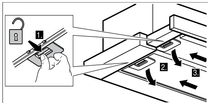
**Υπόδειξη:** Λίπος μπορεί να έχει συσσωρευτεί στο κάτω μέρος στο μεταλλικό φίλτρο λίπους. Κρατάτε οριζόντιο το μεταλλικό φίλτρο λίπους, για να αποφύγετε το στάξιμο του λίπους.
