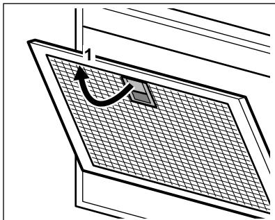
2. Filtreleri aşındırıcı olmayan deterjanlarla bir sünger yardımıyla temizleyin veya bulaşık makinesinde yıkayın.
