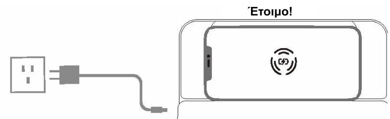
Αφού συνδέσετε το προϊόν σε τροφοδοσία (USB), τοποθετήστε το κινητό τηλέφωνό σας στο κέντρο του σήματος φόρτισης (⌚) ώστε να ξεκινήσει να φορτίζει ασύρματα.
