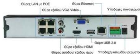
Το NVR μπορεί να συνδεθεί έως και με 9 IP κάμερες και 4 από αυτές μπορούν να είναι IP κάμερες με POE. Υποστηρίζει ανάλυση εγγραφής 4K και σκληρό δίσκο SATA (3.5") χωρητικότητας έως 8 TB. Μπορεί επίσης να υποστηρίξει σύνδεση εξωτερικού συσκευασμένου με 4 σπαστήρες εισόδου και μία έξοδο. Παρακαλούμε συμβουλευτείτε τον ακόλουθο πίνακα τεχνικών χαρακτηριστικών.
