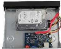
(2) Συνδέστε τη μία άκρη του καλωδίου ρεύματος του σκληρού δίσκου και τη μία άκρη του καλωδίου δεδομένων στο motherboard του NVR και τις αντίστοιχες άλλες άκρες τους στις υποδοχές (ρεύματος και δεδομένων) που υπάρχουν στο σκληρό δίσκο.
