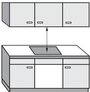
Ανάμεσα στην εστία και σε έναν απορροφητήρα που τοποθετείται από πάνω, πρέπει να τηρείται η απόσταση που συνιστάται από τον κατασκευαστή του απορροφητήρα. Αν παραλείπονται τα στοιχεία αυτά από τον κατασκευαστή του απορροφητήρα ή αν ο απορροφητήρας είναι εξοπλισμένος με πρόσθετα αξεσουάρ, (π.χ. κρεμάστρες από εύφλεκτο υλικό), τότε η ελάχιστη απόσταση που πρέπει να τηρείται είναι 760 χιλστ.
