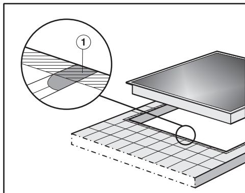
Τα σημεία ένωσης ① και η γραμμωτή περιοχή στην επιφάνεια που πρόκειται να τοποθετηθεί το κάτω τμήμα της συσκευής πρέπει να είναι λεία και ευθυγραμμισμένα, για να εφαρμόσει ομοιόμορφα το πλαίσιο και για να είναι εξασφαλισμένη η απαραίτητη στεγανότητα ανάμεσα στη μόνωση κάτω από το πλαίσιο του πάνω τμήματος της συσκευής και στον πάγκο εργασίας.
