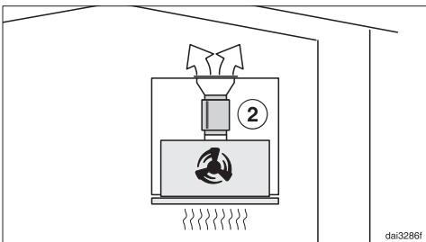
Στη λειτουργία ανακύκλωσης αέρα ο σιγαστήρας τοποθετείται ανάμεσα στο στόμιο εξαγωγής αέρα και τη σχάρα εξερισμού ②. Ελέγχετε τον χώρο τοποθέτησης.
