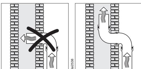
Αν ο εξερχόμενος αέρας οδηγείται σε καπνοδόχο εξαγωγής αέρα, το στόμιο εισαγωγής πρέπει να είναι στραμμένο προς την κατεύθυνση του ρεύματος.
