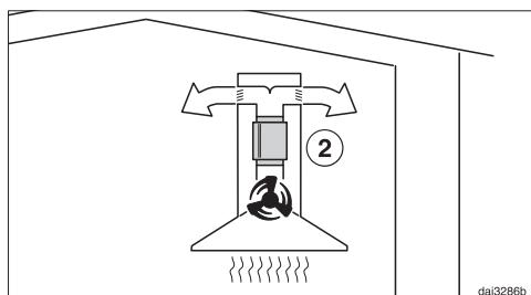
Στη λειτουργία ανακύκλωσης αέρα ο σιγαστήρας τοποθετείται ανάμεσα στο στόμιο εξαγωγής αέρα και τον οδηγό εκτροπής ②. Ελέγχετε τον χώρο τοποθέτησης.
