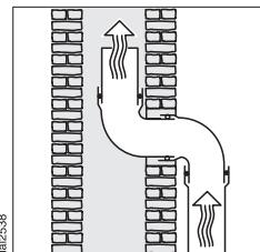
Αν ο εξερχόμενος αέρας οδηγείται σε καπνοδόχο εξαγωγής αέρα, το στόμιο εισαγωγής πρέπει να είναι στραμμένο προς την κατεύθυνση του ρεύματος.
