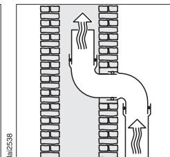
Αν ο εξερχόμενος αέρας οδηγείται σε καπνοδόχο εξαγωγής αέρα, το στόμιο εισαγωγής πρέπει να είναι στραμμένο προς την κατεύθυνση του ρεύματος.
