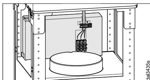
Για τη σωστή σύνδεση πρέπει να χρησιμοποιηθεί το υπάρχον ανακουφιστικό καταπόνησης καλωδίων.
