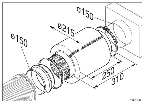
Για πρόσθετη ηχομόνωση μπορεί να τοποθετηθεί ένας σιγαστήρας στον αγωγό εξαγωγής αέρα (πρόσθετο εξάρτημα).
