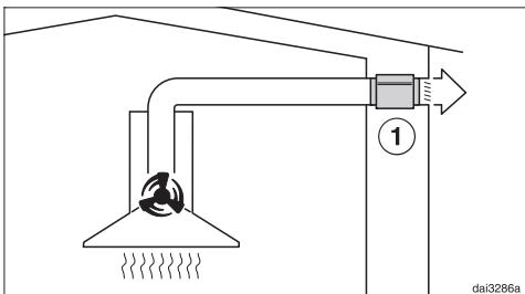
Κατά τη λειτουργία εξαγωγής του αέρα ο σιγαστήρας εξασθενίζει τόσο τους θορύβους της τουρμπίνας μεταφέροντάς τους προς τα έξω, καθώς και τους εξωτερικούς θορύβους οι οποίοι εισέρχονται μέσω του αγωγού εξαγωγής αέρα στην κουζίνα (π.χ. Θόρυβοι από τον δρόμο). Για αυτόν τον λόγο, ο σιγαστήρας τοποθετείται όσο το δυνατόν πιο κοντά στο σημείο εξαγωγής του αέρα ①.
