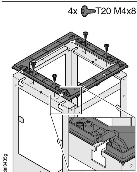
■ Τοποθετείτε το πλαίσιο απόστασης στο πλαίσιο στήριξης.
