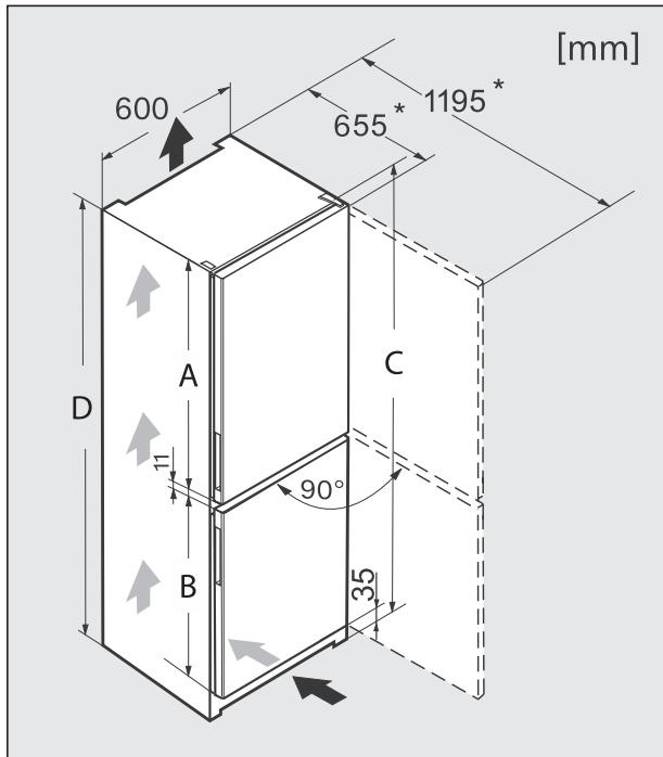
\* Διάσταση χωρίς εγκατεστημένους αποστάτες τοίχου. Αν χρησιμοποιηθούν οι αποστάτες τοίχου, το βάθος συσκευής αυξάνεται κατά 35 mm.
