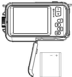
Τοποθέτηση της μπαταρίας λιθίου
