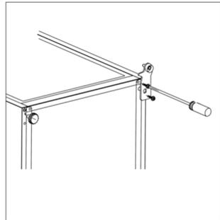
6. Ξεβιδώστε και αφαιρέστε τον κάτω πείρο χρησιμοποιώντας ίσιο κατασαβίδι και στη συνέχεια περιστρέψτε ανάποδα το βραχίονα και τοποθετήστε ξανά τον πείρο.
