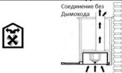
Всасываемый воздух очищается, проходя через жировой фильтр и фильтр с активированным углем, и возвращается на кухню. Угольный фильтр используется, когда возможности установить дымоход в доме нет.
