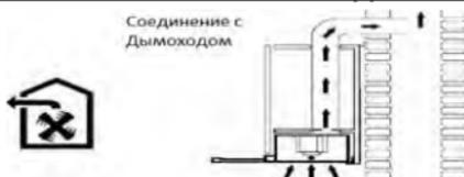
Всасываемый воздух очищается масляными фильтрами и выводится через систему трубопроводов. Диаметр трубы дымохода должен быть равен соединительному кольцу. При горизонтальном расположении труба должна быть слегка наклонена вверх (приблизительно на 10°), чтобы воздух мог беспрепятственно выходить из помещения.
