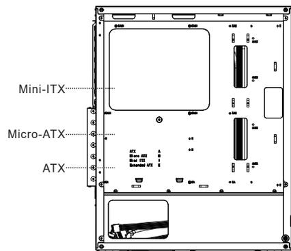
Υποστηριζόμενοι τύποι Μητρικής: ATX/ Micro-ATX/ Mini-ITX
