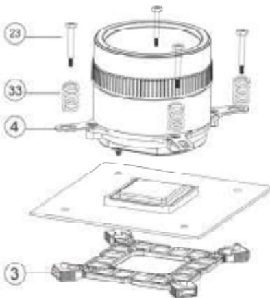
Χρησιμοποιήστε τις βίδες (23) και τα ελατήρια (33) για να σταθεροποιήσετε τους βραχίονες στήριξης (4) μαζί με την αντλία πάνω στη βάση στήριξης Intel (3).
