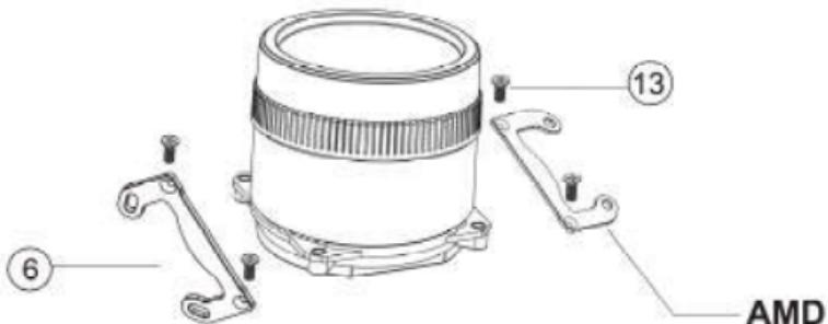
Χρησιμοποιήστε τους βραχίονες στήριξης για AMD (6) και σταθεροποιήστε τους στην αντλία χρησιμοποιώντας τις βίδες βραχίονα στήριξης (13).
