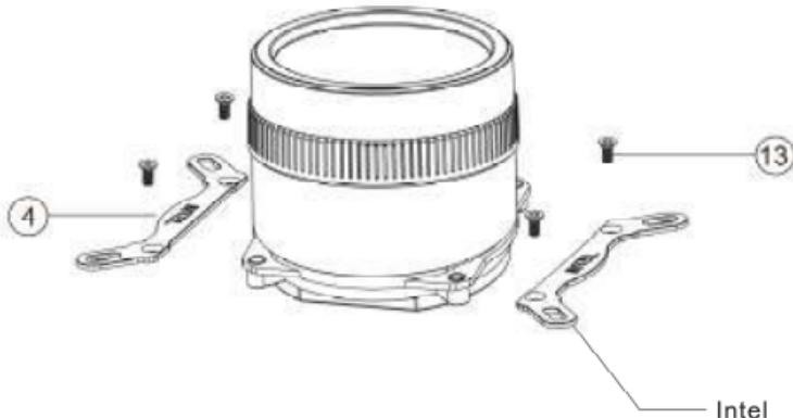
Χρησιμοποιήστε τους βραχίones στήριξης για INTEL (4) και σταθεροποιήστε τους στην αντλία χρησιμοποιώντας τις βίδες βραχίονα στήριξης (13).
