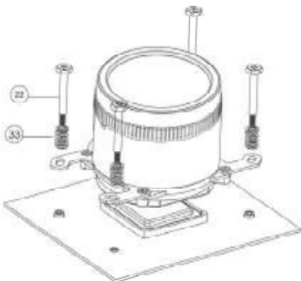
Χρησιμοποιήστε τις βίδες (22) και τα ελατήρια (33) για να σταθεροποιήσετε τους βραχίονες στήριξης στην βάση της μητρικής
