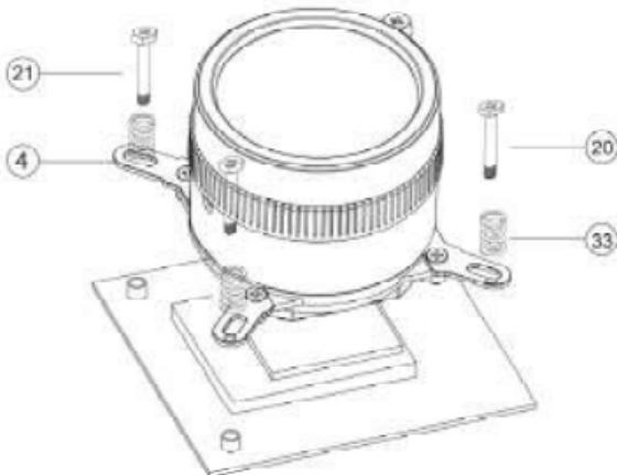
Χρησιμοποιήστε τις βίδες (21) και τα ελατήρια (33) για να σταθεροποιήσετε τους βραχίονες στήριξης (4) στην βάση της μητρικής.
