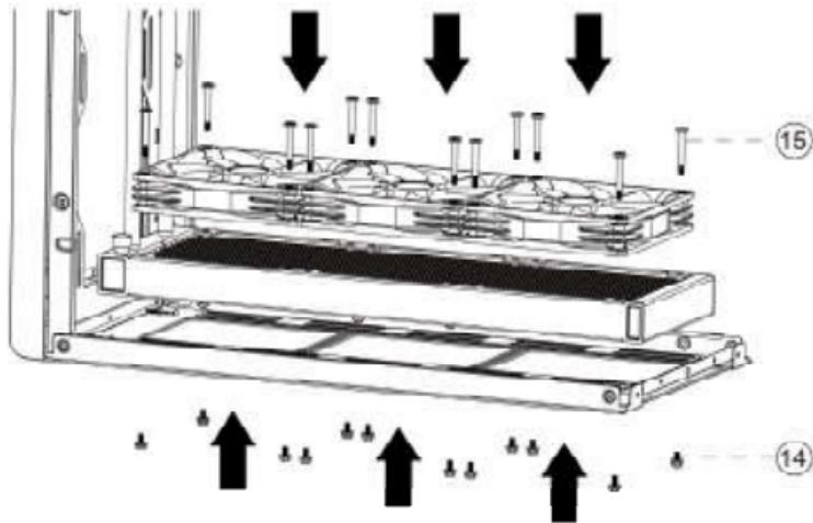
Σταθεροποιήστε το ψυγείο χρησιμοποιώντας τις βίδες ψυγείου (14) και τις βίδες ανεμιστήρα (15).
