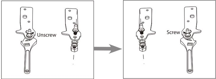
10. Ξεβιδώστε και αφαιρέστε τον κάτω πείρο του μεντεσέ, γυρίστε τον βραχίονα πάνω και επανατοποθετήστε τον
