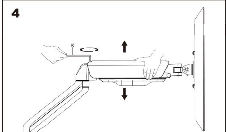
Για σωστή εξισορρόπηση του βραχίονα με τα αναρτημένα μόνιτορ, ρυθμίστε την ένταση του ελατηρίου χρησιμοποιώντας το παρεχόμενο κλειδί Άλεν ως εξής:
