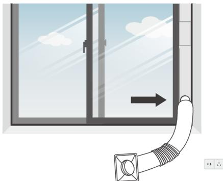
**Βήμα 5:** Συνδέστε το σύνδεσμο σωλήνα στην έξοδο επεξεργασμένου αέρα του φορητού κλιματιστικού.
