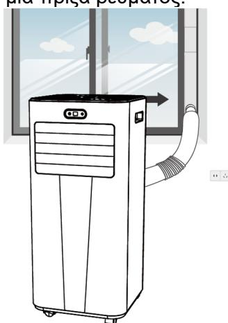
**Βήμα 7:** Ρυθμίστε την περσίδα εξόδου αέρα του φορητού κλιματιστικού και στη συνέχεια ενεργοποιήστε το φορητό κλιματιστικό.
