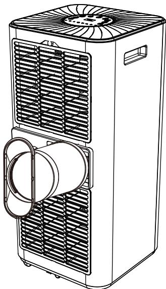
**Βήμα 6:** Ρυθμίστε το μήκος του εύκαμπτου σωλήνα εξαγωγής αέρα και αποφύγετε τα τσακίσματα στο σωλήνα. Προσπαθήστε να είναι όσο το δυνατόν πιο ευθύγραμμος. Στη συνέχεια τοποθετήστε το φορητό κλιματιστικό κοντά σε μια πρίζα ρεύματος.
