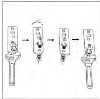
6. Αφού τοποθετήσετε ξανά τους βραχίονες και τους πείρους, τοποθετήστε ξανά και τα δύο ρυθμιζόμενα πόδια.
