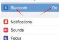
Αριθμός μπειτε στο μενού «Bluetooth» το iPad θα πραγματοποιήσει αυτόματα ανοίγηση για συσκευές Bluetooth. Εντοπίστε το δόναυ του πληκτρολογίου (Sento BT Keyboard) από τη λίστα με τις συσκευές Bluetooth που εντοπίστηκαν και στη συνέχεια πέστε σ' αυτό. Θα πραγματοποιηθεί αυτόματα σύζευξη και σύνδεση μέσω Bluetooth.
